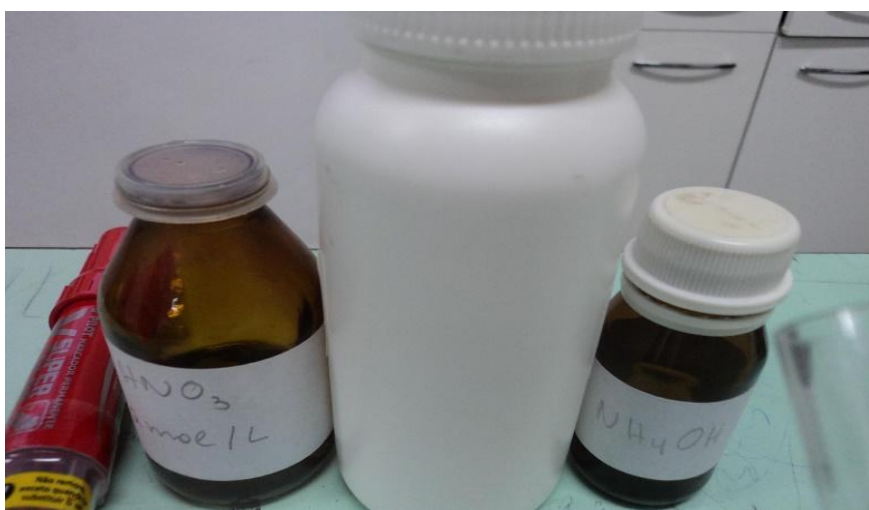
Figura 3: Materiais utilizados na atividade prática sobre pH. Da esquerda para a direita: ácido nítrico ( \text{HNO}_3 ), indicador de pH fenolftaleína e hidróxido de amônio.
