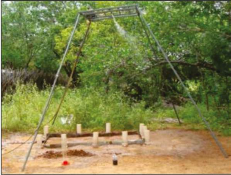
Figura 22 – Estrutura do simulador de chuva (Bezerra Neto, 2014)
