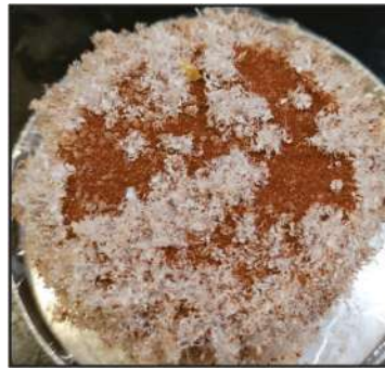
Figura 12 – Cristalización del Cloruro de Potasio en un suelo laterítico
