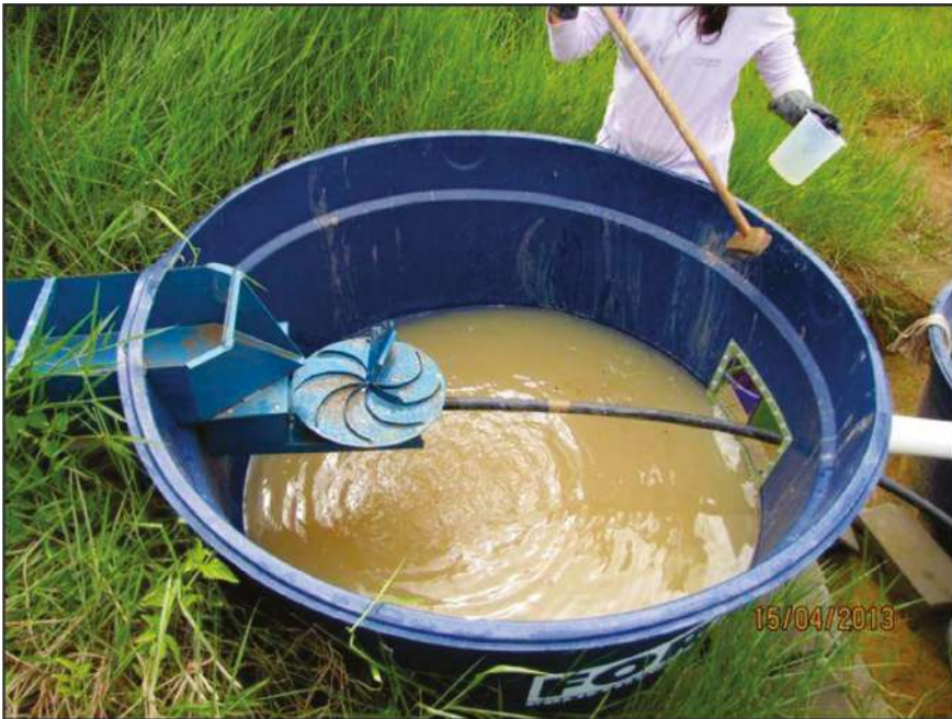
Figura 18 – Roda Coshocton inserida na 1ª caixa de sedimentação cheia e transbordando para a 2ª caixa (Nacinovic, 2013)
