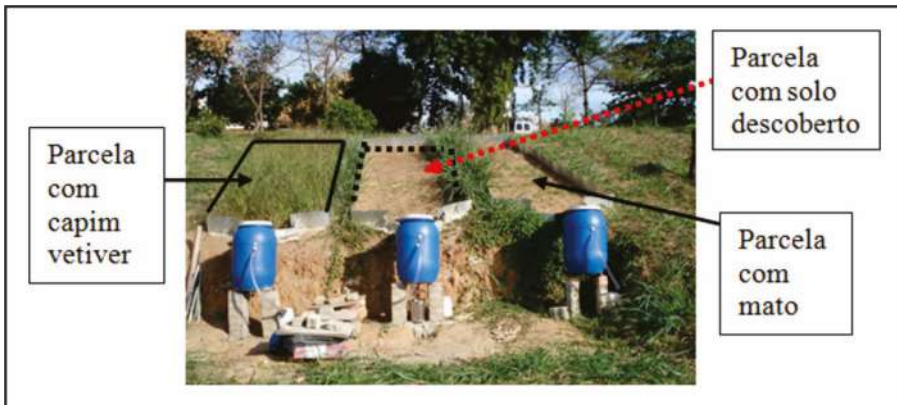
Figura 21 – Três parcelas hidroerosivas instaladas com coberturas de solo diversificadas (Nacinovic, 2013)
