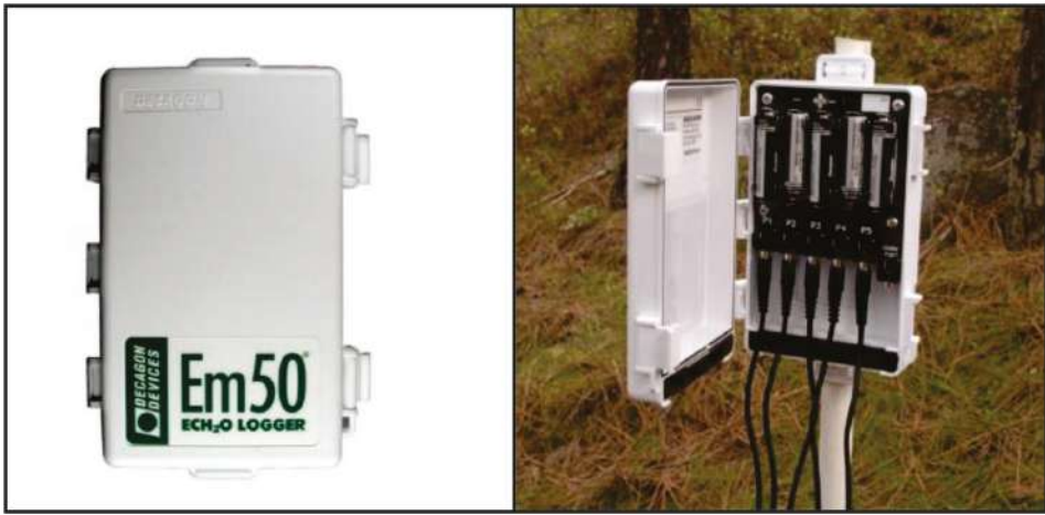
Figura 15 – Recipiente de proteção do datalogger e detalhe do equipamento aberto com as conexões para os sensores (Fonte: www.decagon.com )
