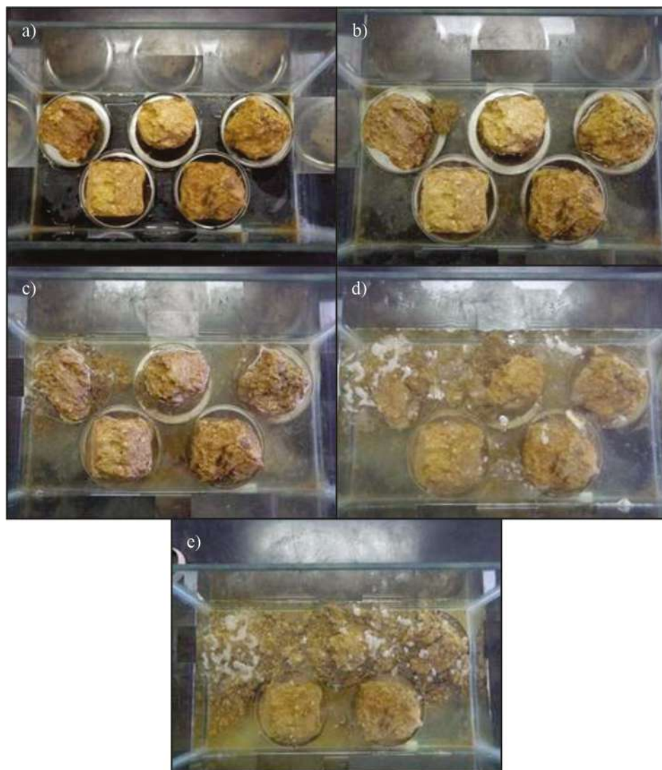
Figura 24 – Etapas do ensaio de desagregação por imersão parcial nas amostras de Cambissolo: (a) nível de água mantido na altura da base das amostras até umedecimento por ascensão capilar; (b) nível de água em 1/3 da altura das amostras por 15 min; (c) nível de água em 2/3 da altura das amostras; (d) submersão total das amostras; (e) final do ensaio após 24h (Almeida, 2014)
