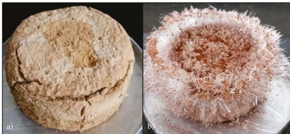
Figura 1 – Efecto de la Urea en la estabilidad estructural de un suelo: a) laterítico; b) saprolítico
