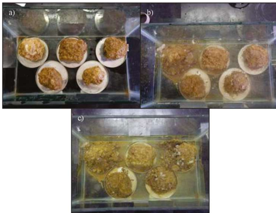
Figura 23 – Procedimentos realizados no ensaio de desagregação por imersão total da amostra de Cambissolo; (a) CPs pré-ensaio; (b) CPs submergidos; (c) término do ensaio após 24h (Almeida, 2014)
