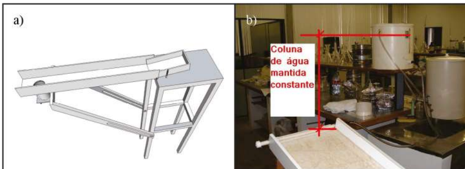
Figura 13 – Inderbitzen: a) Desenho esquemático do aparelho; b) Controle de Vazão (Nacinovic, 2009)
