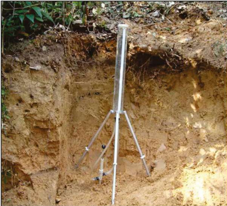
Figura 6 – Esquema do ensaio com Permeâmetro Guleph (aquaesolos.net)
