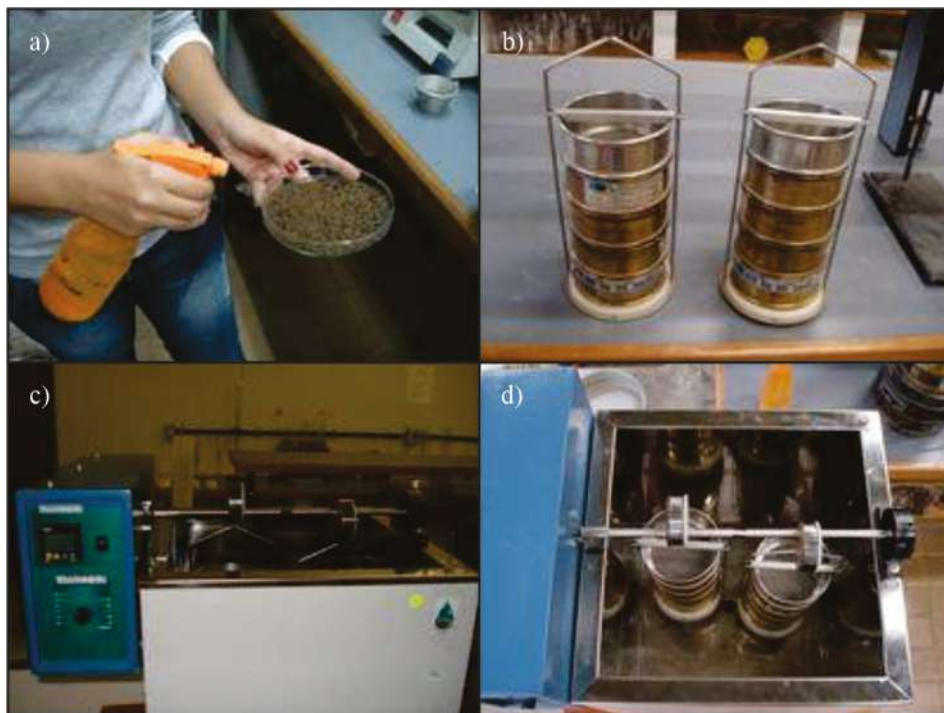
Figura 9 – Ensaio de estabilidade do agregado: a) borrifação da amostra de 25 g com água destilada; b) disposição da amostra em 05 peneiras; c) Aparelho de Yoder; d) peneiras no aparelho de Yoder.
