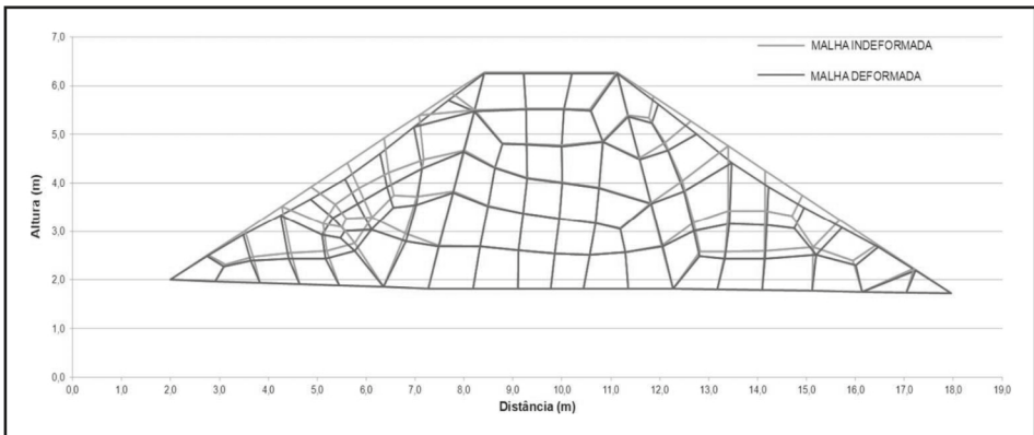
Figura 11 – Deformação para 240 dias. Fator de aumento de deslocamento – 15x.
