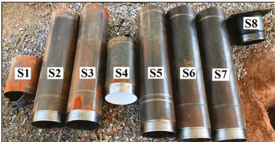
Figura 37 – Segmentos rosqueáveis da estaca tubular de ponta aberta (Galvani Jr., 2020)
