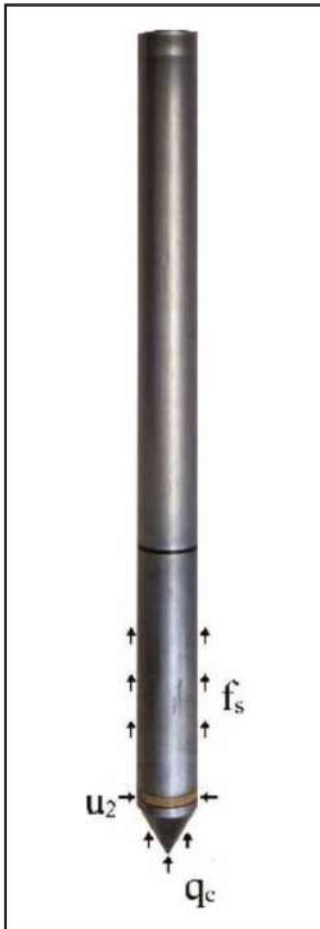
Figura 2 – Ponteira de um piezocone com representação esquemática das medidas da resistência de ponta ( q_c ), do atrito lateral ( f_s ) e da poro-pressão na posição padrão ( u_2 )
