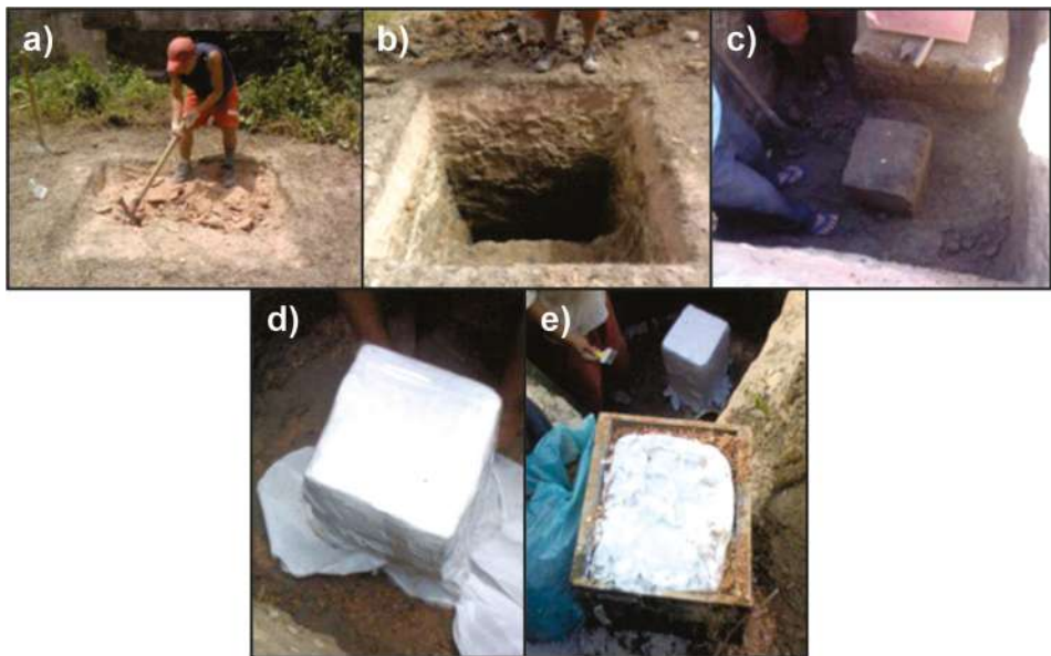
Figura 2 – Moldagem dos blocos: (a) Início da escavação do poço com área de 1,30 m X 1,30 m; (b) Escavação do poço na profundidade 1,20 m; (c) Moldagem de duas amostras na mesma cota; (d) Amarração com fita adesiva do tecido de algodão; (e) Bloco pronto para transporte (Santiago, 2009)
