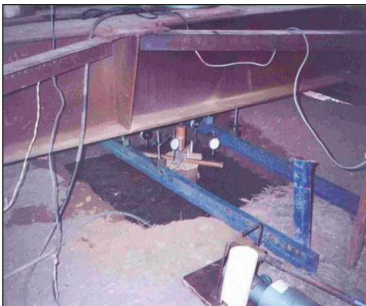
Figura 13 – Prova de carga em estaca com cava para inundação (Campelo, 1994)
