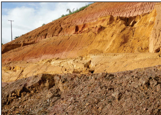
Figura 8 – Perfil de solo residual de rocha sedimentar, Salvador - BA. Foto: Moacyr Schwab.
