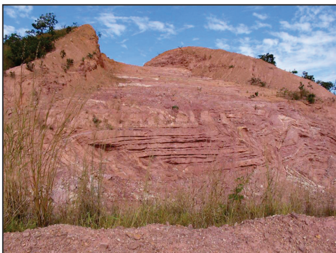
Figura 9 – Perfil Solo Saprolítico na MT 130, Paranatinga, MT. Foto: W. Conciani
