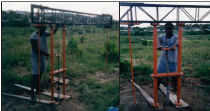
Figura 5 Processo estático para extração de amostra indeformada tipo Shelby, utilizando uma prensa manual (Justino da Silva e Rolim, 2002)
