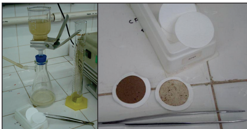
Figura 20 – Kitassato com bomba a vácuo e papel filtro P40 no processo de filtração da amostra de água de escoamento superficial (Nacinovic, 2013)
