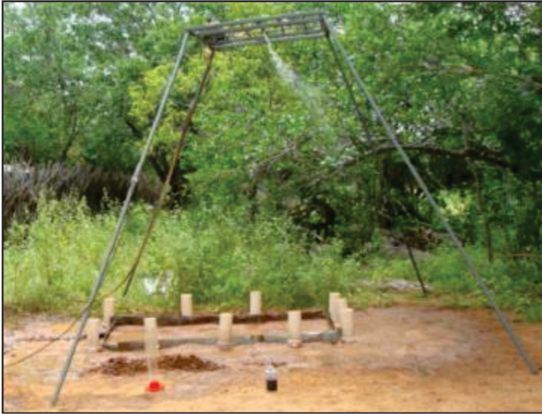
Figura 22 – Estrutura do simulador de chuva (Bezerra Neto, 2014)
