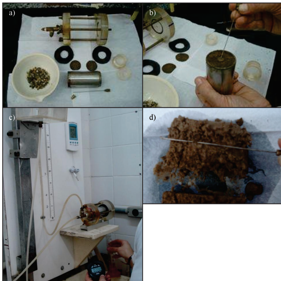
Figura 7 – Pinhole test: a) utensílios necessários para o ensaio; b) inserção de agulha na amostra para perfazer o furo; c) vazão do fluxo sendo medida; d) aferição das dimensões do furo na amostra no final do ensaio (adaptado de Nacinovic, 2013)
