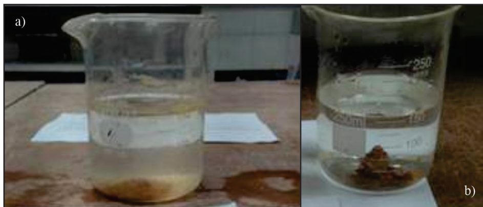
Figura 5 – Resultados do crumb test : levemente dispersivo (a) e não dispersivo (b) (Bezerra, 2022)
