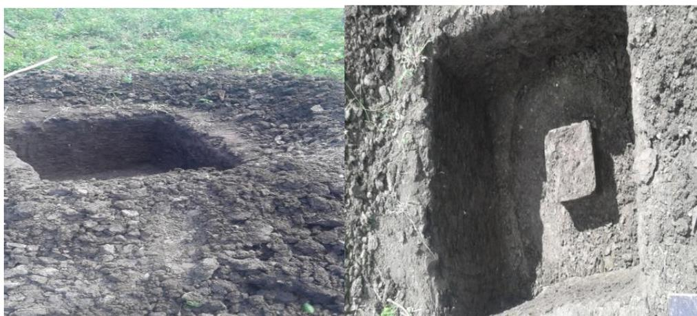
**Figura 6** – Preparação das amostras de solo. a) escavação para retirada de amostra, b) amostra indeformada moldada. Fonte: Maciel (2016)
