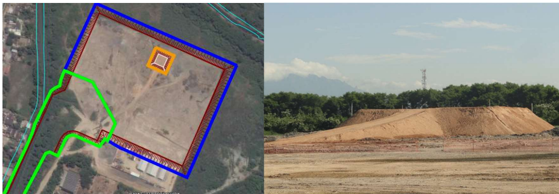
Figura 1. Áreas com e sem tratamento de coluna de brita (adaptado de Google Earth, 2017) e aterro experimental finalizado.
