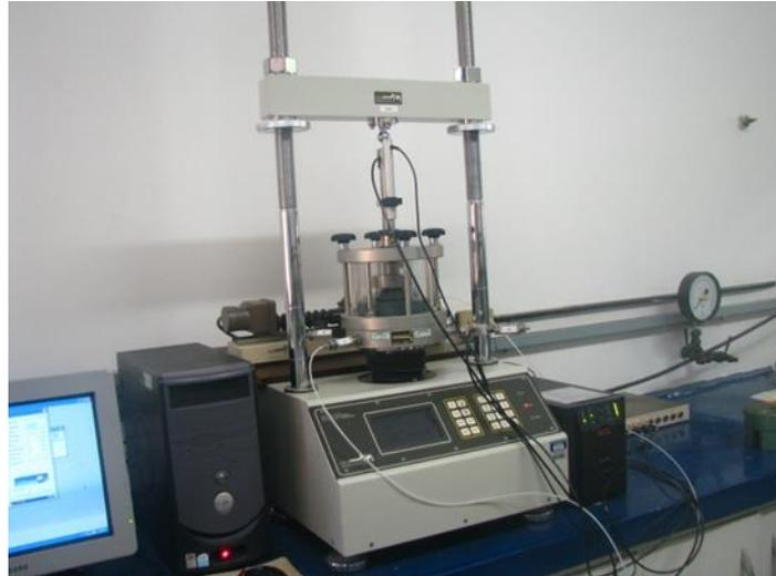
Foto 1. Sistema eletrônico-hidráulico de ensaios de adensamento CRS
