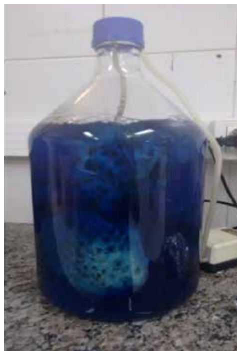
Figura 1 – Reator com biomassa fúngica imobilizada em espuma de poliuretano.
